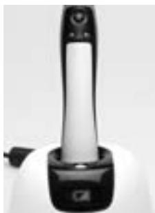
Akumulator jest częścią zamienną, która ulega zużyciu. Zazwyczaj po upływie 2,5 roku powinien być wymieniony na nowy. Data produkcji akumulatora jest podana na naklejce, na jego obudowie.
