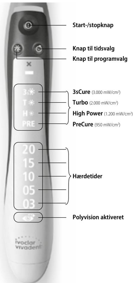
Overhold det anvendte materiales brugsvejledning ved valg af hærdetid og intensitet. Anbefalinger til hærdning af kompositmaterialer gælder for alle nuancer og, hvis der ikke er angivet andet i betjeningsvejledningen, til en maksimal lagtykkelse på 2 mm. Generelt gælder disse anbefalinger i situationer, hvor lyslederens emissionsvindue er placeret direkte over det materiale, der polymeriseres. Hvis afstanden mellem lyslederen og materialet øges, skal hærdetiden forlænges tilsvarende.
